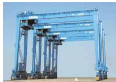
トランスファークレーン(RTG)
